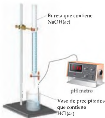
▲ Figura 17.5 Medición del pH durante una titulación. Conjunto de material típico para utilizar un pH metro en la medición de datos para una curva de titulación. En este caso, por medio de una bureta se adiciona una disolución de \text{NaOH} estándar (el titulante) a una disolución de \text{HCl} . La disolución de \text{HCl} se agita durante la titulación para asegurar que la composición sea uniforme.
